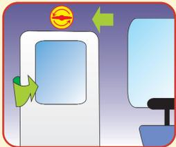
An den Ausstiegstüren befinden sich deutlich sichtbare Nothähne. Bei Gefahr sind diese in Pfeilrichtung zu drehen. Die Tür lässt sich danach manuell aufstoßen. Falls Ihnen dies nicht allein gelingt, bitten Sie Mitreisende um Hilfe.
